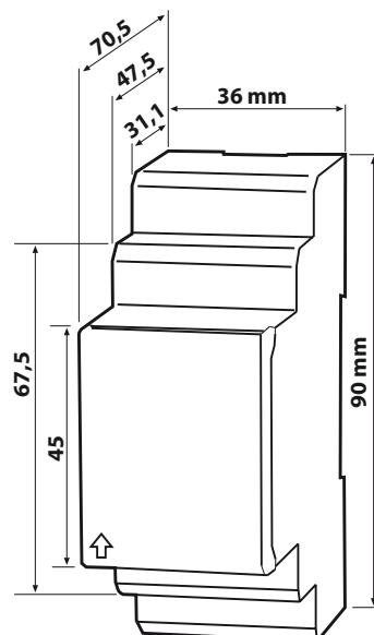
Die Frontplattenabdeckung ist an der mit einem Pfeil gekennzeichneten unteren Seite aufzuklappen.
