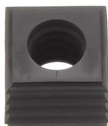
Dichtelement, Montageart: Stecken, Länge x Breite: 20,3 mm, Kabeldurchmesser max.: 12 mm, IP66, Farbe: Schwarz
