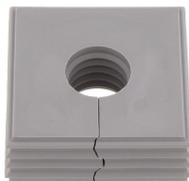
Dichtelement, Montageart: Stecken, Länge x Breite: 42,8 mm, Kabeldurchmesser max.: 16 mm, IP66, Farbe: Grau
