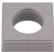
Dichtelement, Montageart: Stecken, Länge x Breite: 42,8 mm, Kabeldurchmesser max.: 27 mm, IP66, Farbe: Grau
