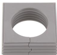
Dichtelement, Montageart: Stecken, Länge x Breite: 42,8 mm, Kabeldurchmesser max.: 30 mm, IP66, Farbe: Grau
