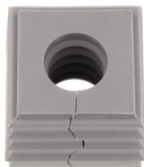
Dichtelement, Montageart: Stecken, Länge x Breite: 20,3 mm, Kabeldurchmesser max.: 10 mm, IP66, Farbe: Grau
