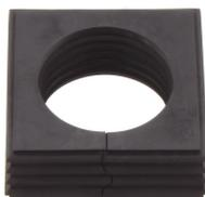
Dichtelement, Montageart: Stecken, Länge x Breite: 42,8 mm, Kabeldurchmesser max.: 30 mm, IP66, Farbe: Schwarz
