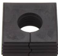
Dichtelement, Montageart: Stecken, Länge x Breite: 42,8 mm, Kabeldurchmesser max.: 20 mm, IP66, Farbe: Schwarz
