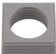
Dichtelement, Montageart: Stecken, Länge x Breite: 42,8 mm, Kabeldurchmesser max.: 32 mm, IP66, Farbe: Grau
