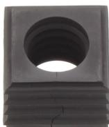
Dichtelement, Montageart: Stecken, Länge x Breite: 20,3 mm, Kabeldurchmesser max.: 13 mm, IP66, Farbe: Schwarz
