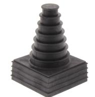
Dichtelement, Montageart: Stecken, Länge x Breite: 42,8 mm, Kabeldurchmesser max.: 24 mm, IP66, Farbe: Schwarz
