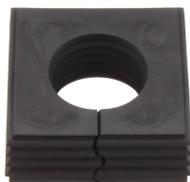
Dichtelement, Montageart: Stecken, Länge x Breite: 42,8 mm, Kabeldurchmesser max.: 24 mm, IP66, Farbe: Schwarz
