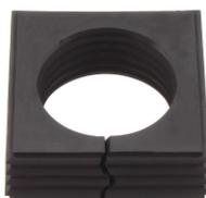
Dichtelement, Montageart: Stecken, Länge x Breite: 42,8 mm, Kabeldurchmesser max.: 31 mm, IP66, Farbe: Schwarz
