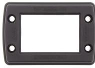
Kabeldurchführung mit eingeschäumter Dichtung, Montageart: Schrauben, Länge: 106 mm, Breite: 70 mm, IP66, Farbe: Schwarz
