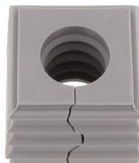
Dichthelement, Montageart: Stecken, Länge x Breite: 20,3 mm, Kabeldurchmesser max.: 11 mm, IP66, Farbe: Grau
