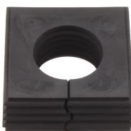
Dichthelement, Montageart: Stecken, Länge x Breite: 42,8 mm, Kabeldurchmesser max.: 24 mm, IP66, Farbe: Schwarz
