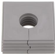
Dichthelement, Montageart: Stecken, Länge x Breite: 42,8 mm, Kabeldurchmesser max.: 16 mm, IP66, Farbe: Grau
