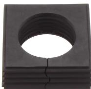
Dichthelement, Montageart: Stecken, Länge x Breite: 42,8 mm, Kabeldurchmesser max.: 29 mm, IP66, Farbe: Schwarz
