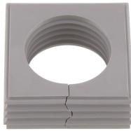
Dichthelement, Montageart: Stecken, Länge x Breite: 42,8 mm, Kabeldurchmesser max.: 30 mm, IP66, Farbe: Grau
