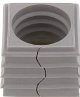
Dichthelement, Montageart: Stecken, Länge x Breite: 20,3 mm, Kabeldurchmesser max.: 17 mm, IP66, Farbe: Grau
