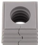
Dichthelement, Montageart: Stecken, Länge x Breite: 20,3 mm, Kabeldurchmesser max.: 12 mm, IP66, Farbe: Grau
