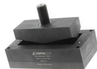
Blechlocher für rechteckige Ausbrüche, Maße Ausbruch: 130 x 46 mm, Maximale Wandstärke: 2,0 mm bei S 235 Blech, Material: Stahl
