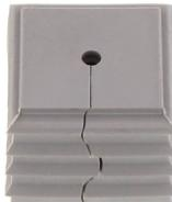
Dichthelement, Montageart: Stecken, Länge x Breite: 20,3 mm, Kabeldurchmesser max.: 3 mm, IP66, Farbe: Grau
