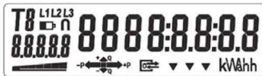
Der Elektrizitätszähler der Serie BM.10 ist mit einem LCD ausgestattet. Der Betriebs- und Temperaturbereich für die korrekte Funktion ist -33 ° C bis +60 ° C. Nach dem Anschluss des E-Zählers an das elektrische Netz erfolgt eine permanente Hintergrundbeleuchtung und es erfolgt ein ca. 3 Sek. dauernder Test aller Segmente der LCD-Anzeige.
