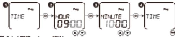
Stellen Sie die aktuelle Uhrzeit, zuerst die Stunden von 0 bis 23, danach die Minuten mit den Knöpfen ▲ bzw ▼ und bestätigen Sie jede Eingabe mit »Ok«.
