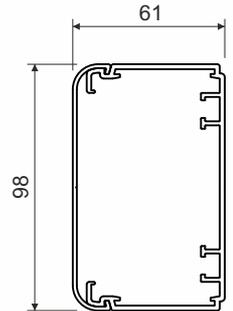
Produktbeschreibung: geeignet zur Verlegung von Niederspannungsleitungen
