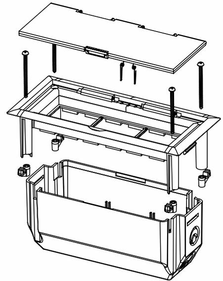
**Produktbeschreibung:** Geräteinsatz für die Montage in Möbel, Hohlwände oder Doppelböden (Plattenstärke 9-38 mm)
