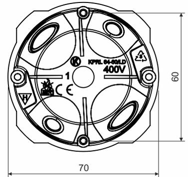
Produktbeschreibung: geeignet für Leitungen mit einer Spannung bis 400V und einer Stromstärke bis max. 16 A
