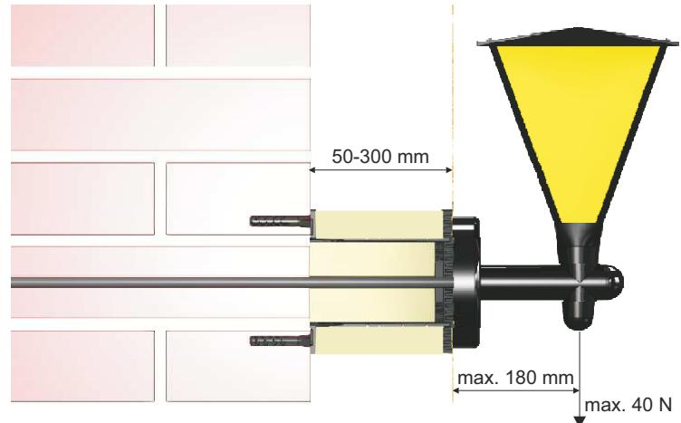
Vor der Montage ist die Halterung inkl. beigelegter Isolierung auf die benötigte Länge, entsprechend der Wärmedämmungsstärke zu kürzen.
