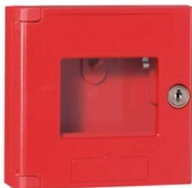
Legrand Schlüsselkasten IP 44 - IK07, leer, mit Signalkontakt 4-48 V DC/100 mA zur Meldung z.B. "Kasten geöffnet". Hammer mit Kette nicht im Lieferumfang, optional bestellbar (Best.-Nr. 001391), Abmessung (HxBxT): 125 x 125 x 45, Farbe: Rot, Schutzklasse II, drei Vorprägungen PG 7/ M 12 für Leitungseinführung. Schlüsselkasten für Aufputzmontage.
