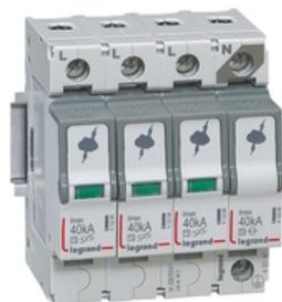
Legrand Überspannungsableiter Typ 2/Class II nach IEC/EN 61643-11, 3+1 Schaltung, für TT und TN-S Systeme, Nennspannung 230/400 V AC, Ableitstoßstrom  $I_{max} (8/20)$  40 kA/Pol. Höchste Dauerspannung ( $U_c$ ) 320 V AC. Zum Schutz vor Überspannungen nachgeordneter Verbraucher durch indirekte Blitzeinschläge oder Schalthandlungen. Mit Plug-in Schutzmodul und Statusanzeige: Grün (SPD betriebsbereit) Orange (Plug-in Schutzmodul austauschen).
