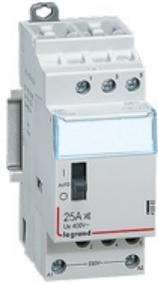
Legrand Installationsschutz CX3, Spulenspannung AC 230 V, 4-polig, Ausführung: 4 Schließer, Bemessungsbetriebsstrom Ie 25 A/ 400 V AC, mit Handschalter. Nach EN 61095, Gebrauchskategorie AC-1/AC-7a und AC-3/AC-7b, Installationsschütze zum Schalten von Lasten wie z.B. Lampengruppen, Motoren und Heizungen, mit Beschriftungsfenster, mit Schaltzustandsanzeige, Befestigung auf Hutprofilschiene EN 60715 durch rastende Schnellbefestigung, Anbau von Hilfsschaltern möglich.
