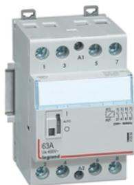
Legrand Installationsschutz CX3, Spulenspannung AC 230 V, 4-polig, Ausführung: 4 Schließer, Bemessungsbetriebsstrom Ie 63 A/ 400 V AC, mit Handschalter. Nach EN 61095, Gebrauchskategorie AC-1/AC-7a und AC-3/AC-7b, Installationsschütze zum Schalten von Lasten wie z.B. Lampengruppen, Motoren und Heizungen, mit Beschriftungsfenster, mit Schaltzustandsanzeige, Befestigung auf Hutprofilschiene EN 60715 durch rastende Schnellbefestigung, Anbau von Hilfsschaltern möglich.
