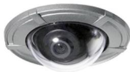
Minidome-Farbkamera zum Frontplatteneinbau (Briefkasten, Klingeltableaus etc.), witterfest, Stromversorgung 12 V DC 130 mA, mittels mitgeliefertem Videosignalwandler und 12 V-Steckverbinder, geeignet zum direkten Anschluss an das Kamerainterface Art. 347400, Videoausgang FBAS 1 Vss/75 Ohm, 0,15 Lux, Objektiv 3,7 mm, Einbauloch-Durchmesser: 67 mm, Gesamtdurchmesser: 88 mm, Einbautiefe: 58,5 mm.
