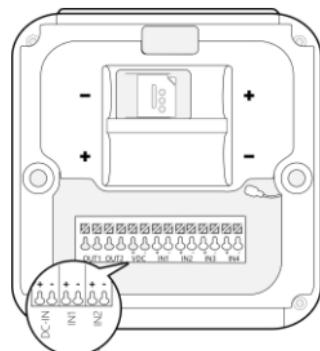
Ein zweiter Sensor kann am Eingang 2, 3, oder 4 angeschlossen werden.
