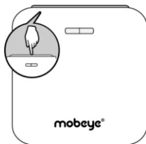
Im ausgeschalteten Status wird der Mobeye CM4040 keine Alarmsmeldungen senden. Die Funktionen "automatische Einschaltung", "Senden der Testmeldungen" und "Senden einer Batteriestandmeldung" sind noch aktiv.
