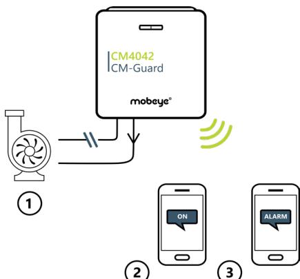
Der Mobeye CM4042 überwacht verschiedene Fehlerkontakte oder Sensoren in Ihrer Installation und bietet die Möglichkeit ein Gerät, eine Pumpe oder einen Motor aus der Ferne zu schalten.
