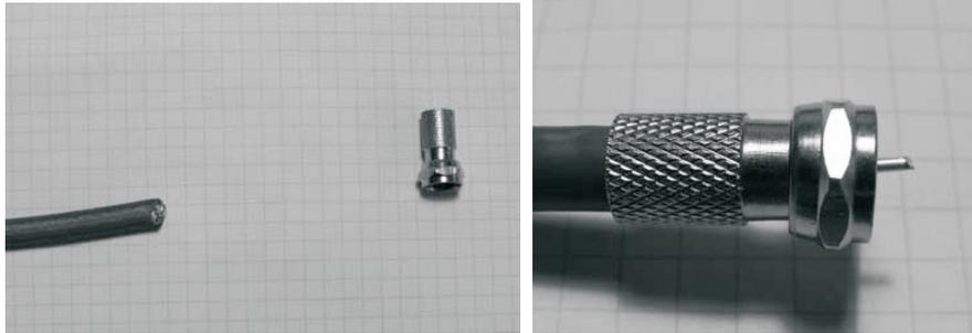
1. Koaxialkabel abisolieren:
