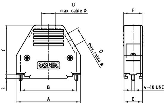
Gehäuse mit Gleitverschluss
