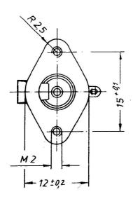
Kontaktdruck ≥ 1N Kontaktabstand ≥ 0,4 mm Verdrehmoment von Scheiben und Lötanschlüssen gegeneinander ≥ 5Ncm
