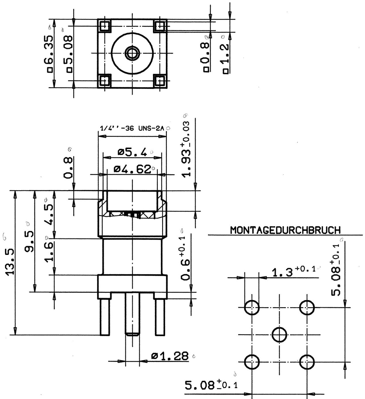
ANMERKUNG: IN DER 13-STELLIGEN BESTELL-NR. IST MIT DER 13-TEN ZAHLE DIE OBERFLAECHE "1" GLEICH INDUSTRIE-AUSFUEHRUNG, MIT "2" GLEICH VG-AUSFUEHRUNG ODER MIT "9" GLEICH VERNICKELTE AUSFUEHRUNG ANZUGEBEN.
