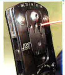
5. Bei der Entnahme des fertigen Kabels ist die Positioniereinrichtung etwas nach vorne zu ziehen, so dass sich das Kabel leichter entnehmen lässt.
