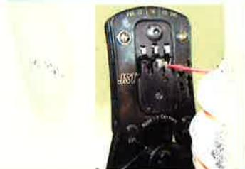
4. Der Crimpvorgang wird ausgeführt, indem Sie die Werkzeuggriffe vorsichtig zusammendrücken. Sobald die Crimpbacken vollständig ineinander fassen, wird die Ratsche automatisch gelöst und das Kabel mit dem angecrimpten Kabelschuh kann entnommen werden.
