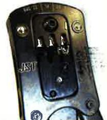
3. Überprüfen Sie die Übereinstimmung des Kabelquerschnitt mit dem zu verwendeten Crimpkontakt. Führen Sie das Kabel in die entsprechende Öffnung des Werkzeuges bis zum Kabelanschlag ein.
