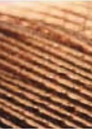
Als Leiterwerkstoff kommt bei unseren Leitungen überwiegend Kupfer (Cu) zum Einsatz. Für die Produktion von Drähten wird hauptsächlich **Cu-ETP1** (Sauerstoffhaltiges Kupfer) und **Cu-OF 1** (Sauerstofffreies Kupfer für besondere Anforderungen, z.B. Wasserstoffbeständigkeit) eingesetzt. Neben reinem Kupfer verarbeiten wir auch verschiedene Kupfer-Legierungen für spezielle Anwendungen.
