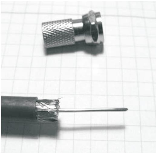
1. Koaxialkabel abisolieren:
