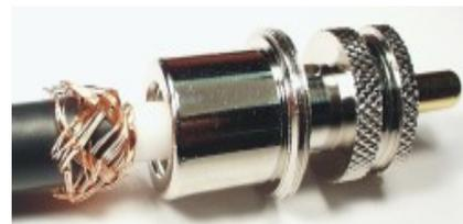
Steckerhülse über das Kabel schieben. Steckergehäuse auf das Kabelende einschrauben.
