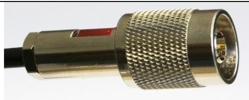
**8.** Das so vorbereitete Kabelende bis zum Anschlag (Klick) in das Steckers-Gehäuse einschieben. Mit zwei Maul Schlüsseln 11 mm die Spannmutter handfest anziehen.
