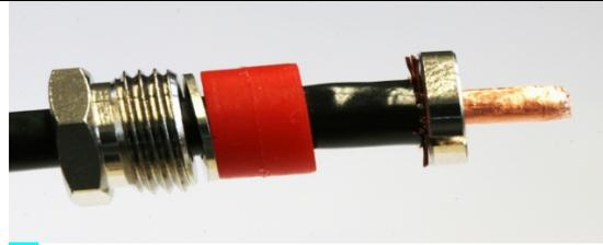
**5.** Die Kontakthülse bis zum Anschlag zwischen dem Kupfergeflecht und der Folie einschieben. Das Kupfergeflecht mit dem Seitenschneider abschneiden. Die Länge 6 mm von Kupferfolie mit scharfem Messer anritzen und entfernen, dann 5 mm von geschäumtes Dielektrikum ebenso entfernen.
