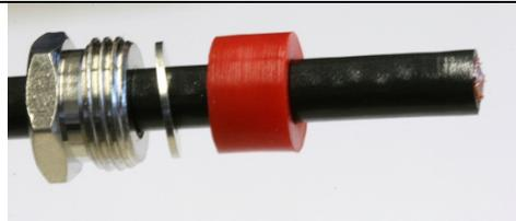
**2.** Schieben Sie die Spannmutter, die Scheibe und die Gummidichtung über das Kabelende.
