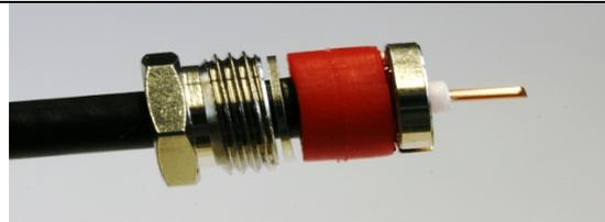
**6.** Die Gummidichtung nach vorne zur Kontakthülse verschieben. So dass den Rest vom Geflecht zwischen der Gummidichtung und der Kontakthülse eingeklemmt ist.
