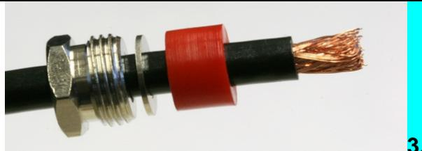
**3.** Mit einem Messer 8 mm des Außenmantels entfernen.
