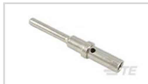
Kabelschuh/Kontakt-Typ: **Stift**Stiftdurchmesser: **1.59 mm [.062 in]**Klemme überträgt: **0-24 A (niedrige Leistung)**Drahtgröße: **.5 – 1.5 mm<sup>2</sup>**[Alle DEUTSCH Kontakte \(46\)](#)**Eigenschaften****Produktmerkmale**
