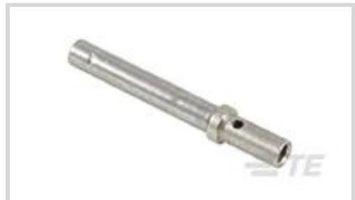
Kabelschuh/Kontakt-Typ: **Stecksocket**Stiftdurchmesser: **1 mm [.04 in]**Klemme überträgt: **0-24 A (niedrige Leistung)**Drahtgröße: **.5 mm<sup>2</sup>**[Alle DEUTSCH Kontakte \(46\)](#)
