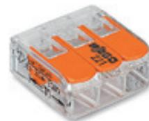
COMPACT-Verbindungsklemme für alle Leiterarten; 3-Leiter-Klemme; mit Betätigungshebeln; max. Umgebungstemperatur 85°C
