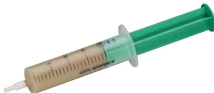
WAGO „Alu-Plus“ Kontaktpaste für das sichere Verdrahten von eindrähtigen Aluminium-Leitern ❶ bis 4 mm<sup>2</sup> in WAGO Federklemmen. Es ist kein Reinigen und Fetten des Aluminium-Leiters mehr erforderlich, denn die WAGO „Alu-Plus“ Kontaktpaste wird stattdessen mit der praktischen Füllspritze direkt in die Leitereinführungsöffnung der WAGO Klemmen gefüllt.
