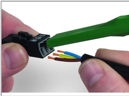
Zum Anschluss feindrätiger Leiter alle Klemmfedern mittels Betätigungswerkzeug 890-383 öffnen, und abisolierte Leiter bis zum Anschlag einführen.
