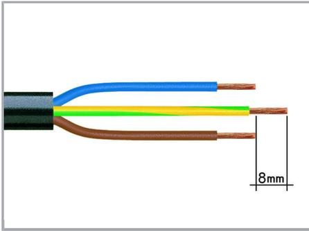
1. Abmantelllänge = 30 mm (2-polig), 37 mm (3-polig), 45 mm (4- und 5-polig)
