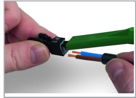
Zum Anschluss feindrätiger Leiter beide Klemmfedern mittels Betätigungswerkzeug 890-382 öffnen, und abisolierte Leiter bis zum Anschlag einführen.
