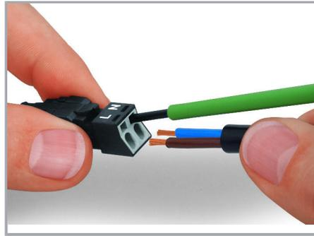
Zum Anschluss feindrätiger Leiter Klemmfeder mittels Schraubendreher, Klingenbreite 2,5 mm, betätigen und abisolierten Leiter bis zum Anschlag einführen.
