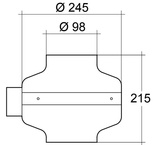
Rohr-Radialventilator NW 100, verzinkt
