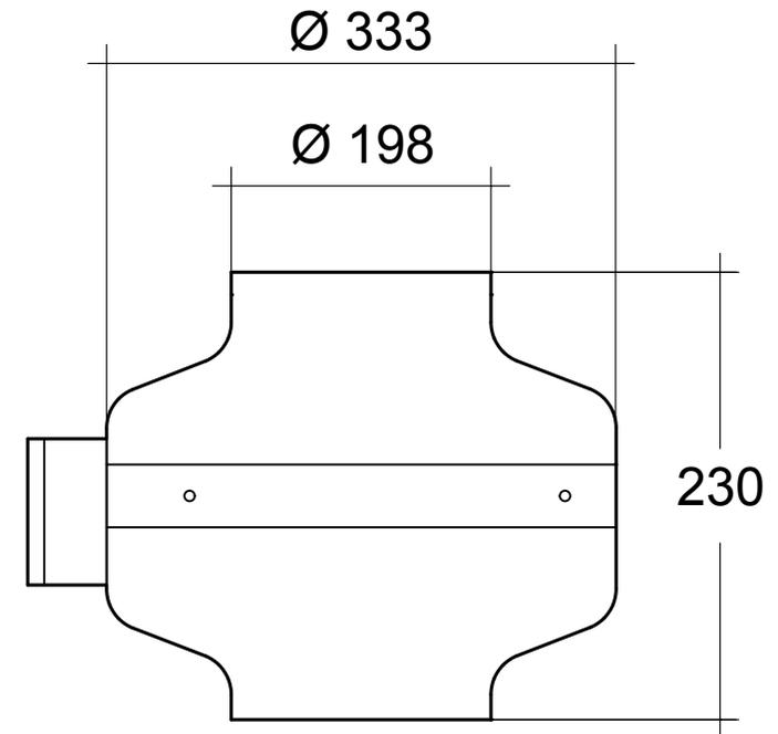
Rohr-Radialventilator NW 200, verzinkt
