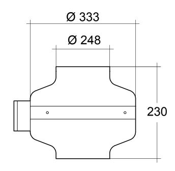
Rohr-Radialventilator NW 250, verzinkt Material: verzinkt
