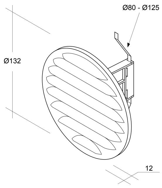
Außengitter m. Klemmfeder RG 130 Material: Edelstahl
