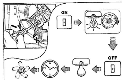
Pro zvýšení nebo snížení časového zdržení vypněte přístroje (od 3 do 25 minut) pootočte dolaďovacím regulačním šroubem, znázorněným na obrázku.
