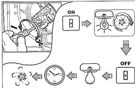
Actionați asupra trimmer-ului (șurubului) de reglare, indicat în figură, pentru a crește sau a reduce întârzierea de oprire a echipamentului (de la 3 la 25 minute).
