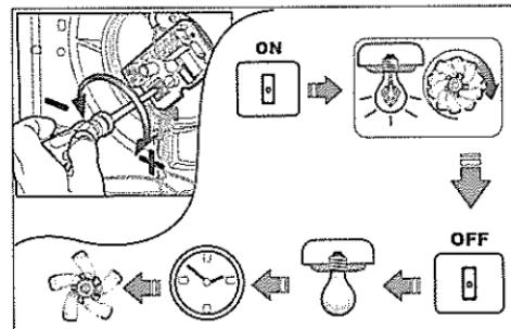
Använd inställningsskruven som visas i figuren för att öka eller minska den försenade släckningen av apparaten (från 3 till 25
