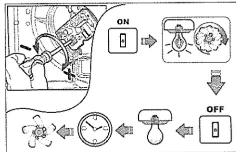
Drej trimmeren (stilleskruen), der er vist i figuren, for at indstille tidsrummet for slukning af apparatet (efter 3-25 minutter).
