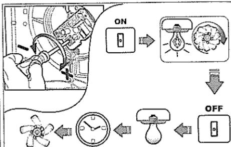
Pre zvýšenie alebo zníženie oneskorenia zapnutia zariadenia (od 3 do 25 minút) použite regulačnú skrutku (trimmer).
