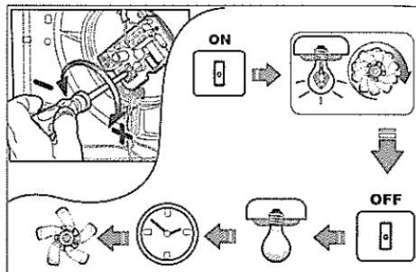
Agir sur le trimmer (vis) de régulation (voir schéma) pour augmenter ou réduire le retard d'extinction de l'appareil (de 3 à 25 minutes).
