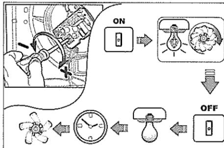
Draai aan de trimmer (schroef), die men in de afbeelding ziet, om de uitschakelvertraging van het apparaat te verhogen of te verlagen (van 3 tot 25 minuten).
