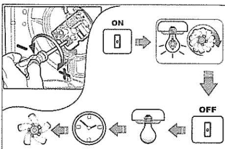
Verstellen Sie den Regeltrimmer (Schraube) in der Abbildung, um die Abschaltverzögerung des Geräts (von 3 auf 25 Minuten) zu erhöhen bzw. zu reduzieren.
