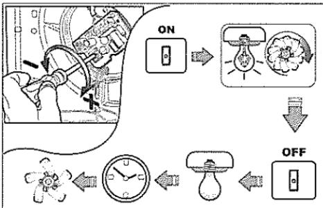
Agire sul trimmer (vite) di regolazione mostrato in figura per aumentare o ridurre il ritardo di spegnimento dell'apparecchio (da 3 a 25 minuti).
