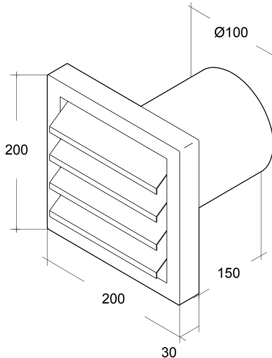
Edelstahl-Außengitter Rundanschluß 100 m. Stutzen u. RSK N31845
