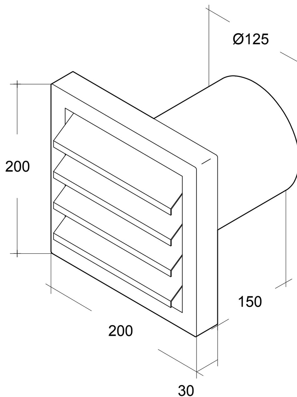
Edelstahl-Außengitter Rundanschluß 125 m. Stutzen u. RSK N31846
