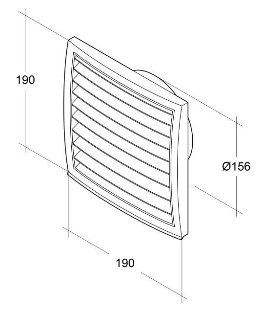
Aussengitter Rundanschluss 150, mit Fliegennetz, weiß N32860 Stand 24.11.2010 Material: Kunststoff
