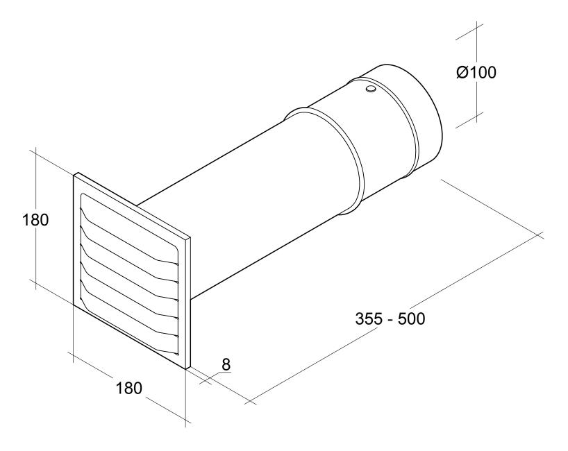
Teleskop-Rundrohrmauerkasten 100 m. RSK Material: Edelstahl
