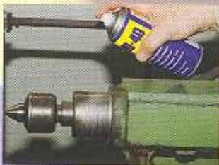
Schmiert und reinigt die Mitlaufspitze an Drehmaschinen
