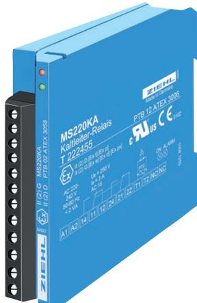
Motorschutzgerät zum Einsatz als Schutzeinrichtung gegen unzulässige Erwärmung an elektrischen Betriebsmitteln in gasexplosionsgefährdeten Bereichen (Zonen 1 und 2) und in Bereichen mit brennbarem Staub (21 und 22), z.B. zur direkten Temperaturüberwachung explosionsgeschützter Motoren der Zündschutzart Ex e und Ex d
