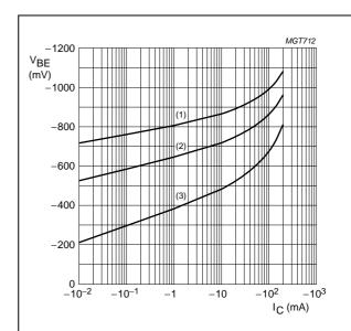
**BC857A;**  $V_{CE} = -5 \text{ V}.$
