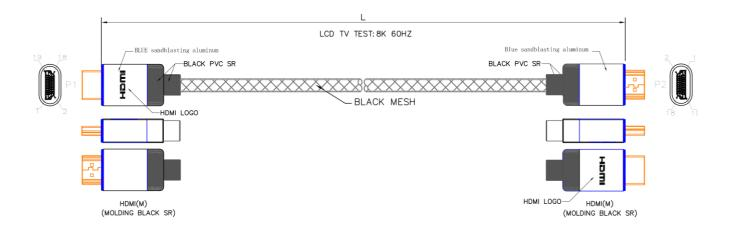
E314459 兄 AWM 20276 80℃ 30V VW-1 HIGH SPEED HDMI<sup>®</sup> CABLE WITH ETHERNET
