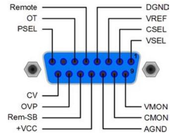
**Achtung! Niemals Massen der analogen Schnittstelle mit dem Minusausgang einer externen Steuereinheit verbinden, wenn dieser mit dem Minusausgang des Gerätes verbunden ist (Masseschleife). Es kann Laststrom über die Steuerleitungen fließen und das Gerät sowie die Steuereinheit beschädigt werden!**
