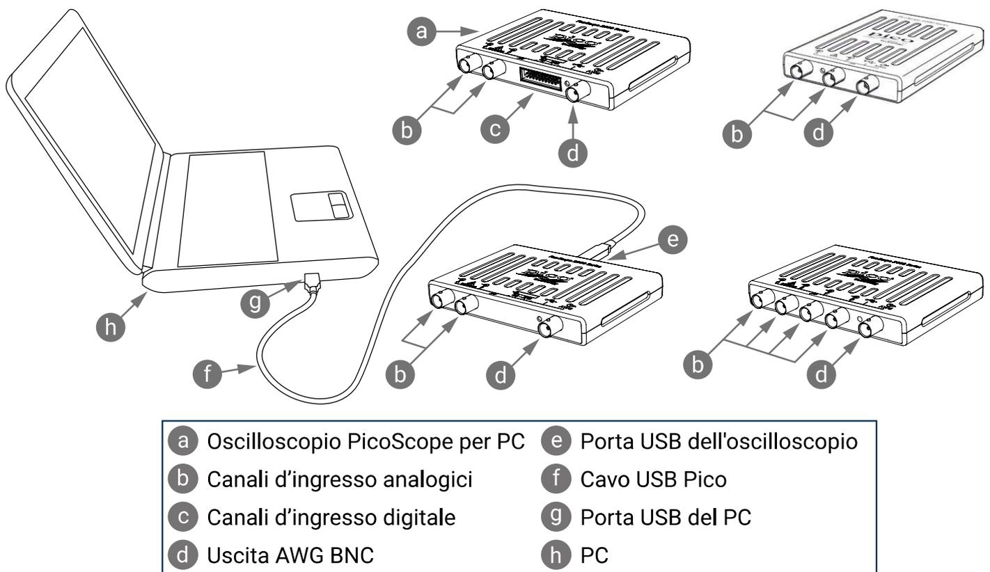
2. Attendere che il computer installi l'oscilloscopio. Durante l'installazione l'utente visualizzerà un messaggio o un'icona nella barra delle applicazioni che indica che è stato trovato il dispositivo.
