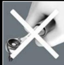
Das Aufsetzen einer Verlängerung zur Erreichung höherer Drehmomente ist nicht zulässig.
